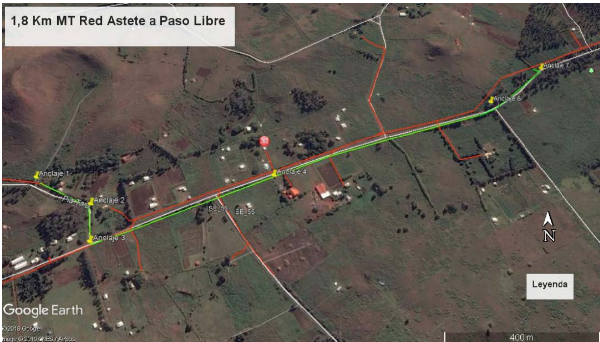
Figura 3. Etapa 1 Refuerzo de 1800 mts línea MT sector Astete a Vai Tea
