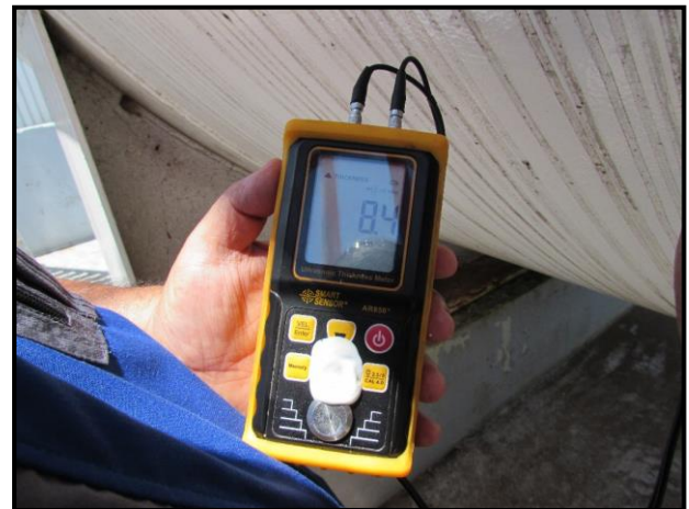
Fotografía N°6: muestra registro de medición de espesores de manto del tanque.
